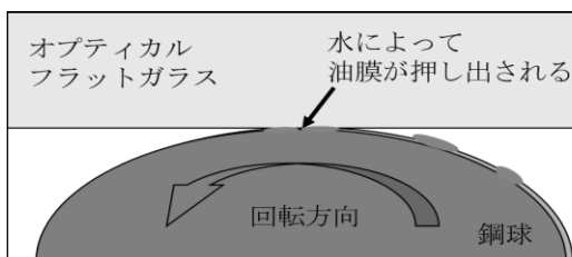
図 15 水道水混入による油膜喪失
