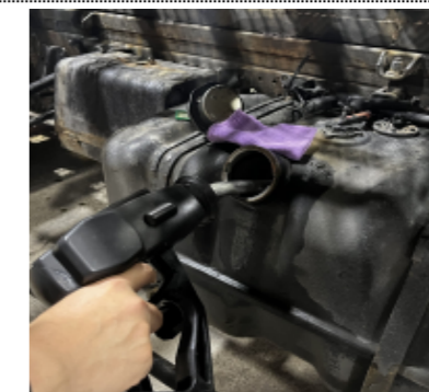
「満タン法」は給油方法によって誤差ができるため、基準を設けて慎重に給油しました。
