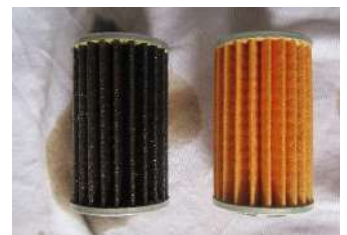
汚れたストレーナー交換②
