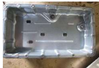
清掃後のオイルパン
