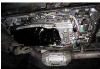
塩カリで取付けボルト折れ
