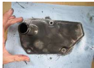
汚れたストレーナー交換①
