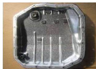
清掃後のオイルパン
