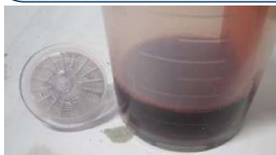
摩耗度は2.0 フルード汚れ
