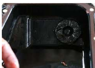
汚れたオイルパン
