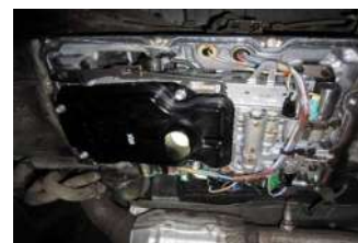
ボルト折れを修正したAT
