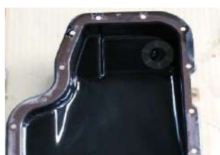
清掃後のオイルパン
