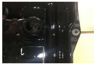
ATストレーナーの汚れ
