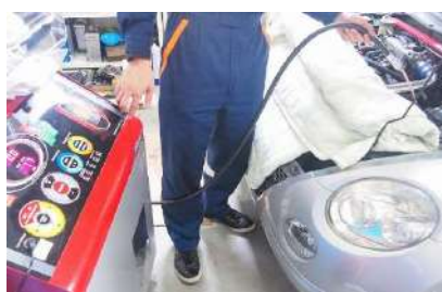
チェンジャーによる注入
