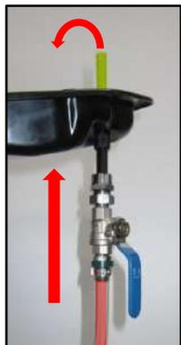
フルード量の確認時、エアバルブを**横**にすることでホース内とオーバーフロー分のフルードが戻ってくるため、ホースを外さずに油量の確認ができる。
