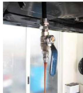
チャックの採用により作業性向上
