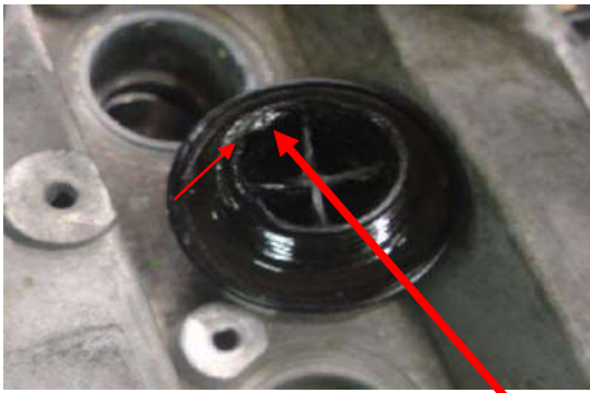
エンジン焼付きを起した車両の フィラーキャップ
