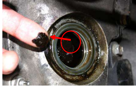
オイル注入口のプレート部分を触るとスラッジ が手に付く状態です。
