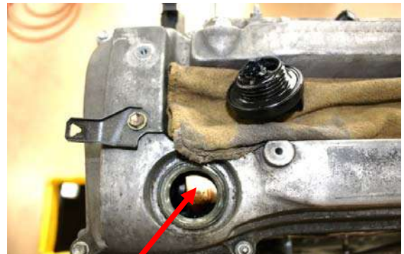
エンジン焼付きを起した車両の オイル注入口
