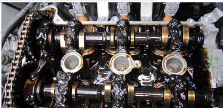
ヘドロ状のスラッジが付着しオイルも泥濁状態
