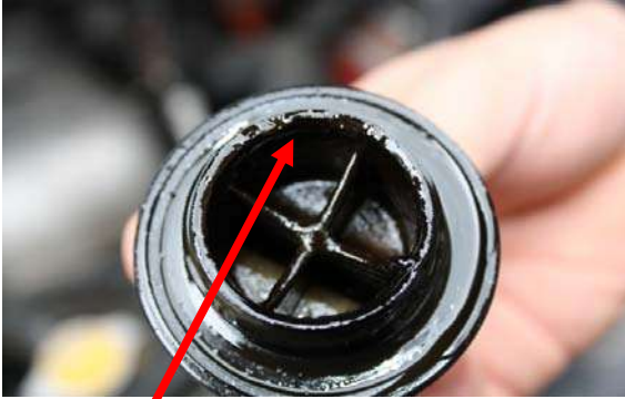
ドロツとしたオイルが付着している。
